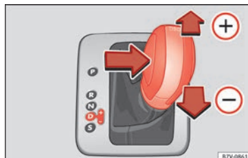
Abb. 203 Wählhebel in Tiptronic-Stellung (Linkslenker). Rechtslenker spiegelbildlich.
