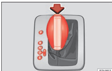
Abb. 48 Automatisches Getriebe: Wählhebelsstellungen.
