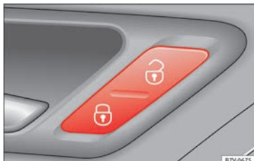
Abb. 2 An der Fahrertür: Zentralverriegelungstaster.
