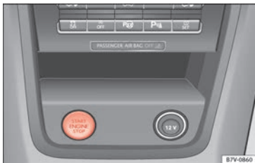
Abb. 199 In der Mittelkonsole: Starterknopf des schlüssellosen Schließ- und Startsystem Keyless Access. Bei Rechtslenker-Fahrzeugen ist die Anordnung symmetrisch.
