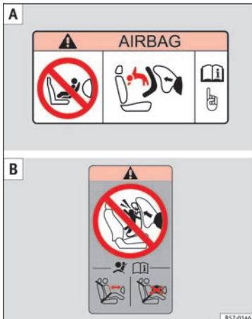
Abb. 35 Airbagaufkleber - Version 2: an der Beifahrer-Sonnenblende A und am hinteren Türrahmen des Beifahrers B .
