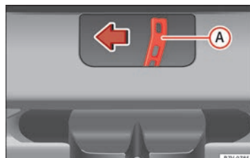
Abb. 9 Vom Gepäckraum aus: Heckklappe notentriegeln.
