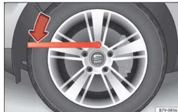
Abb. 67 Radwechsel: Radschrauben lockern.
