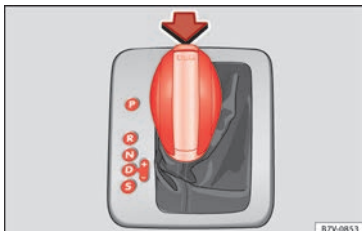
Abb. 202 Wählhebel des automatischen Getriebes mit Sperrtaste (Pfeil).
