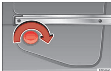
Abb. 236 Hinten links im Gepäckraum: AdBlue-Tank, hinter einer Abdeckung. »
