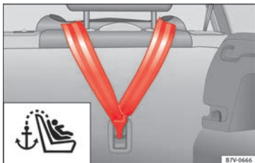
Abb. 38 Eingehängter oberer Befestigungsgurt im Gepäckraum.
