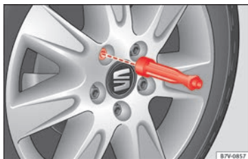
Abb. 71 Radwechsel: Radschrauben mit dem Schraubendrehergriff abschrauben.
