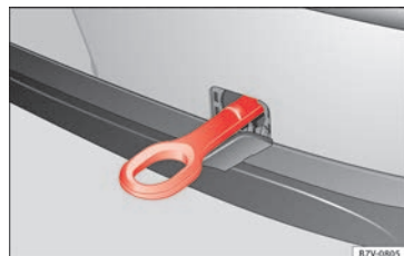
Abb. 104 Im Stoßfänger hinten rechts: Eingeschraubte Abschleppöse.
