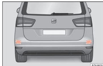
Abb. 221 Bereich hinter dem Fahrzeug: Bereiche der Radarsensoren.
