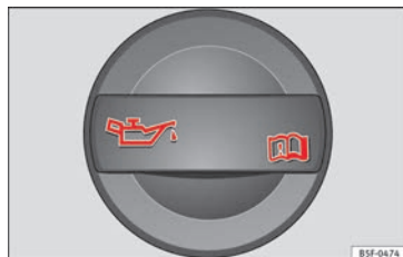
Abb. 55 Deckel der Motoröl-Einfüllöffnung im Motorraum
