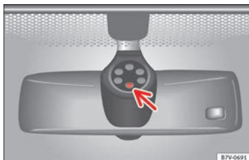
Abb. 145 Sensitive Fläche des Regensensors.
