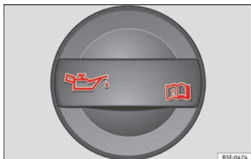
Abb. 242 Im Motorraum: Deckel der Motoröleinfüllöffnung.
