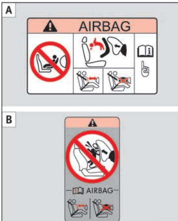
Abb. 34 Airbagaufkleber - Version 1: an der Beifahrer-Sonnenblende A und am hinteren Türrahmen des Beifahrers B .
