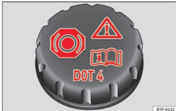
Abb. 246 Im Motorraum: Deckel des Bremsflüssigkeitsbehälters
