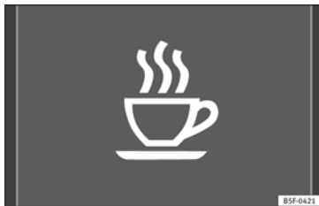
Abb. 226 Im Display des Kombiinstrumentes: Symbol für Müdigkeitserkennung.
