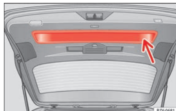
Abb. 137 Offene Heckklappe: Griffmulde zum Zuziehen
