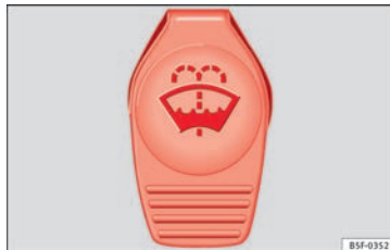
Abb. 58 Im Motorraum: Deckel des Scheibenwaschbehälters.
