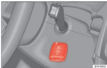
Abb. 200 Notstart bei Fahrzeugen mit Keyless Access.
