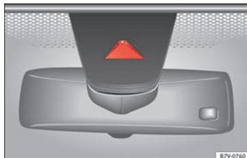
Abb. 219 An der Frontscheibe: Kamerasichtfenster des Spurhalteassistenten.
