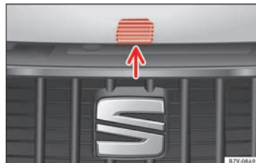
Abb. 239 Entriegelungshebel zum Öffnen der Motorraumklappe im Kühlergrill.
