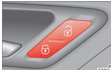
Abb. 130 An der Fahrertür: Zentralverriegelungstaster.
