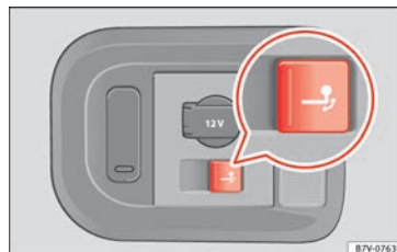
Abb. 229 Gepäckraum rechts: Taste zum elektrischen Schwenken des Kugelkopfs.
