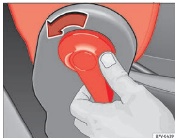
Abb. 160 Klappbare Beifahrersitzlehne entriegeln.
