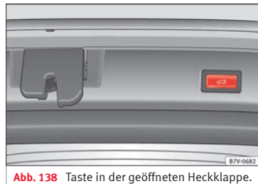
Abb. 138 Taste in der geöffneten Heckklappe.
