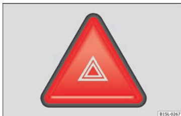
Abb. 42 Instrumententafel: Schalter für die Warnblinkanlage
