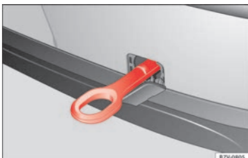
Abb. 73 Im Stoßfänger hinten rechts: Eingeschraubte Abschleppöse.
