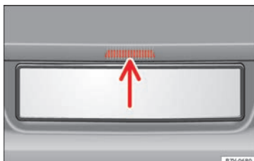
Abb. 7 Heckklappe von außen öffnen.
