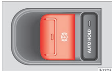
Abb. 201 Detail der Mittelkonsole: Schalter für elektronische Parkbremse.
