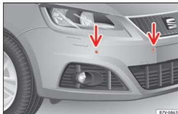
Abb. 209 Sensoren der Parkdistanzkontrolle vorn im Stoßfänger.
