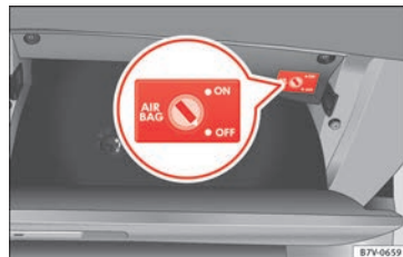
Abb. 92 Im Handschuhfach, auf der Beifahrerseite: Schlüsselschalter zum Ab- und Einschalten des Beifahrer-Frontairbags.
