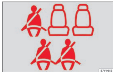
Abb. 83 Beispiel der Gurtstatusanzeige für die hinteren Sitzplätze (hier beim 7-Sitzer) im Kombiinstrument: oben zweite Sitzreihe, unten dritte Sitzreihe.
