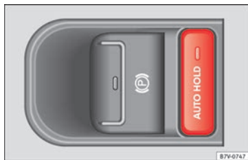
Abb. 206 Ausschnitt aus der Mittelkonsole: Taster für Auto Hold
