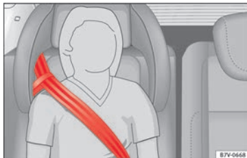
Abb. 96 Integrierter Kindersitz: Gurtbandverlauf mit Gurtführungsschleufe.
