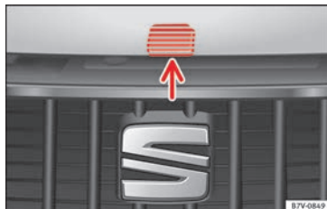
Abb. 11 Hebel unter der Motorraumklappe.
