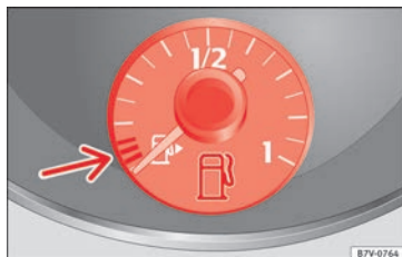
Abb. 234 Im Kombiinstrument: Kraftstoffvorratsanzeige für Benzin und Diesel.
