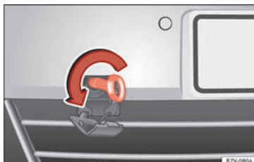
Abb. 103 Im Stoßfänger vorn rechts: Abschleppöse einschrauben.
