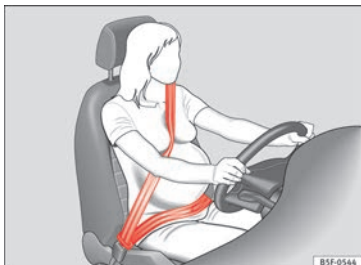
Abb. 88 Gurtbandverlauf bei schwangeren Frauen.
