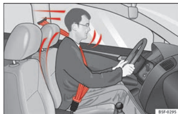
Abb. 84 Angegurteter Fahrer, der bei einem plötzlichen Bremsmanöver vom richtig angelegten Sicherheitsgurt aufgefangen wird.
