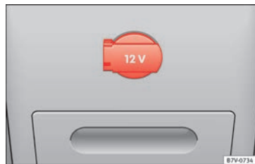
Abb. 193 Hintere Seite der Mittelkonsole: 12-Volt-Steckdose.
