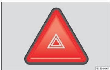
Abb. 140 Ausschnitt von der Instrumententafel: Schalter für die Warnblinkanlage
