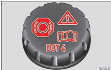
Abb. 57 Motorraum: Deckel des Bremsflüssigkeitsbehälters
