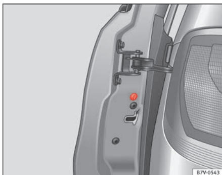
Abb. 189 In der Stirnseite der Beifahrertür: Notverriegelung, durch eine Gummidichtung abgedeckt.
