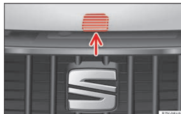
Abb. 241 Entriegelungshebel zum Öffnen der Motorraumklappe im Kühlergrill.
