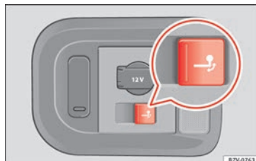
Abb. 231 Gepäckraum rechts: Taste zum elektrischen Schwenken des Kugelkopfs.
