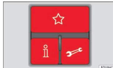
Abb. 123 Drei-Tasten-Modul im Himmel: Bedienelemente des Telefonsteuerungssystems.
