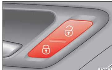
Abb. 130 An der Fahrertür: Zentralverriegelungstaster.
