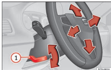
Abb. 24 Lenkradposition mechanisch einstellen.
