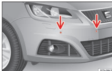
Abb. 209 Sensoren der Parkdistanzkontrolle vorn im Stoßfänger.
