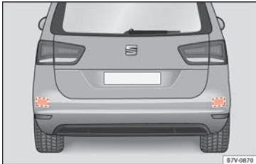
Abb. 223 Bereich hinter dem Fahrzeug: Bereiche der Radarsensoren.
