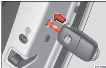
Abb. 5 Notverriegelung des Fahrzeugs mit dem Fahrzeugschlüssel.
