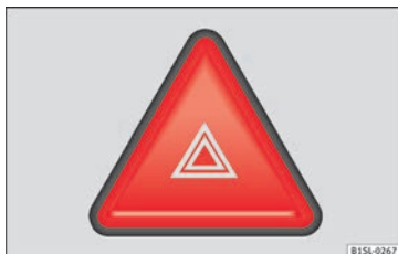
Abb. 42 Instrumententafel: Schalter für die Warnblinkanlage
