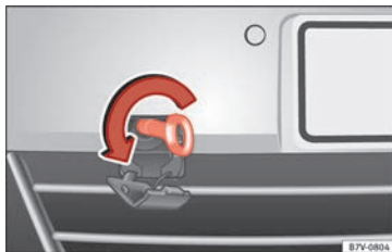
Abb. 103 Im Stoßfänger vorn rechts: Abschleppöse einschrauben.
