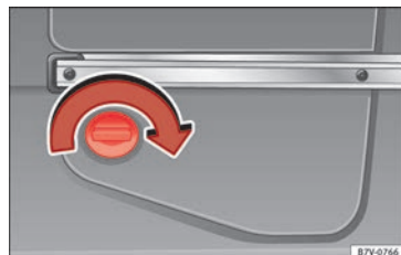
Abb. 238 Hinten links im Gepäckraum: AdBlue-Tank, hinter einer Abdeckung.
