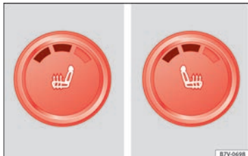
Abb. 154 Ausschnitt aus der Mittelkonsole: Regler für die Sitzheizung der Vordersitze, hier bei eingestellter zweiter Heizstufe.
