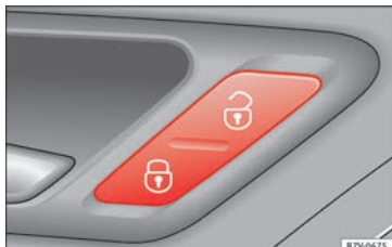
Abb. 2 An der Fahrertür: Zentralverriegelungstaster.
