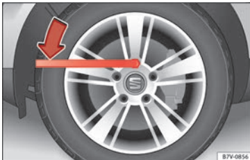
Abb. 67 Radwechsel: Radschrauben lockern.
