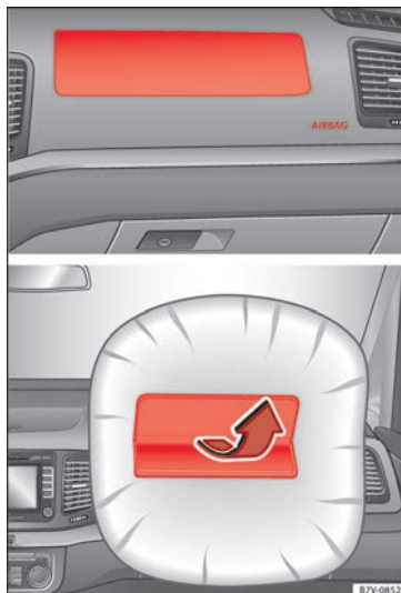
Abb. 26 Einbauort und Wirkungsbereich des Beifahrer-Frontairbags.
