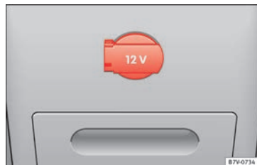
Abb. 193 Hintere Seite der Mittelkonsole: 12-Volt-Steckdose.
