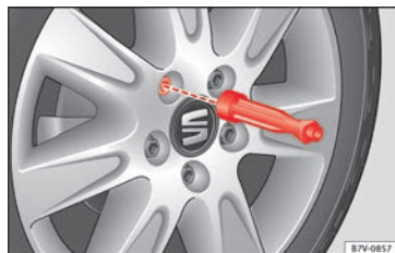
Abb. 71 Radwechsel: Radschrauben mit dem Schraubendrehergriff abschrauben.
