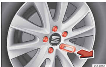
Abb. 80 Rad: Radschrauben mit Deckel.
