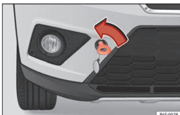
Abb. 107 Vorderer Stoßfänger rechts: Eingeschraubte Abschleppöse
