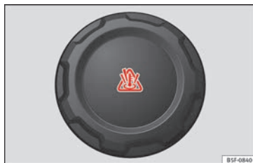
Abb. 67 Motorraum: Deckel des Motorkühlmittelausgleichsbehälters
