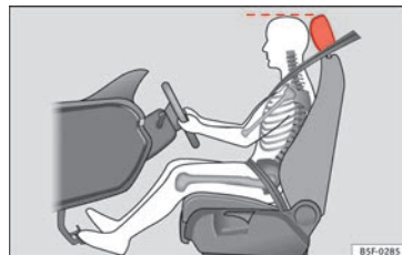
Abb. 93 Die richtige Kopfstützeinstellung des Fahrers.
