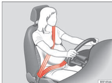
Abb. 102 Gurtbandverlauf bei schwangeren Frauen.
