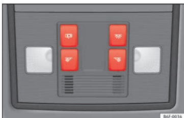
Abb. 42 Ausschnitt aus Dachhimmel: Innenbeleuchtung vorn.
