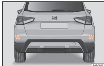
Abb. 202 Bereich hinter dem Fahrzeug: Bereiche der Radarsensoren.
