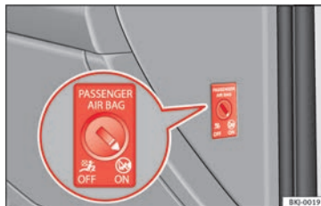
Abb. 103 Schlüsselschalter zum Ein- und Abschalten des Beifahrerairbags.
