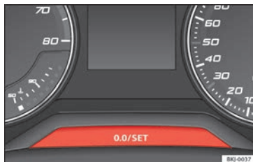
Abb. 126 Kombi-Instrument: Kilometerzähler und Rückstelltaste.
