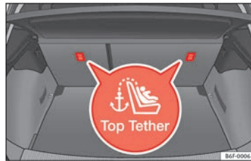
Abb. 32 Lage der Top Tether-Ösen im hinteren Teil des Rückensitzes
