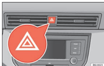
Abb. 41 Instrumententafel: Schalter für die Warnblinkanlage
