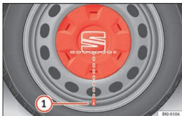
Abb. 77 Korrekte Anbringung der Radvollblende für Stahlfelgen.
