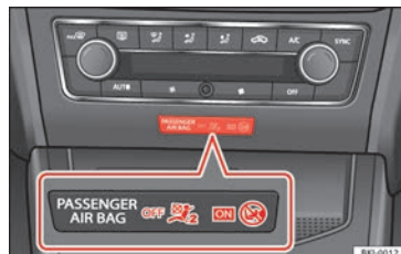
Abb. 104 Instrumententafel-Mittelteil: Kontrollleuchte für abgeschalteten Beifahrer-Frontairbag.
