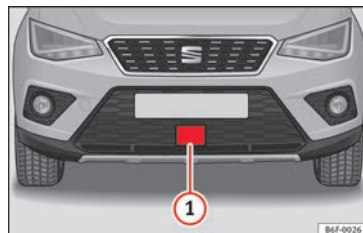
Abb. 195 Im vorderen Stoßfänger: Radarsensor.
