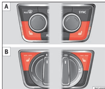
Abb. 154 In der Mittelkonsole: Regler für die Sitzheizung der Vordersitze. A : Ausführung mit Climatronic. B : Ausführung mit manueller Klimaanlage.
