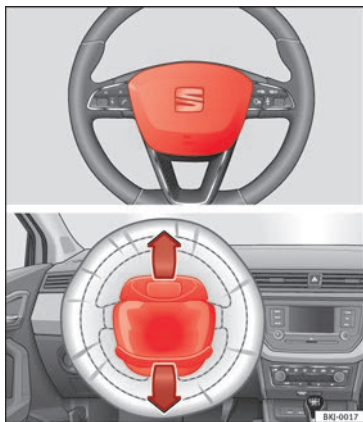
Abb. 20 Einbauort Fahrerairbag: im Lenkrad.
