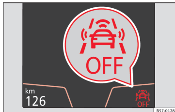
Abb. 191 Auf dem Display des Kombi-Instruments: Anzeige, dass Front Assist ausgeschaltet ist.
