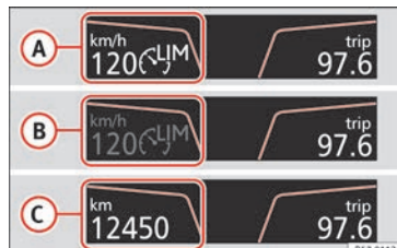
Abb. 186 Im Display des Kombiinstrument: Anzeige des Zustands des Geschwindigkeitsbegrenzers.
