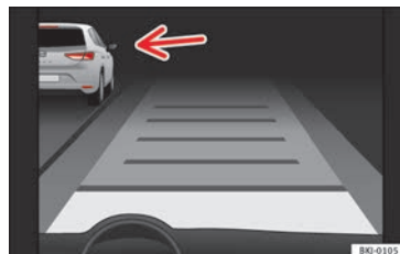
Abb. 198 Im Display des Kombiinstrument: ACC aktiv, Fahrzeug auf der linken Seite erkannt
