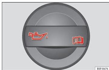
Abb. 66 Deckel der Motoröl-Einfüllöffnung im Motorraum
