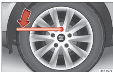
Abb. 81 Radwechsel: Radschrauben lockern
