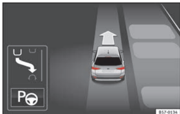
Abb. 211 Im Display des Kombiinstruments: Anzeige des Parklenkassistenten mit eingeschränkter Sicht.
