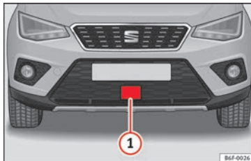
Abb. 190 Im vorderen Stoßfänger: Radarsensor.
