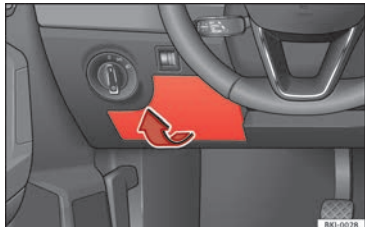
Abb. 70 Auf der Fahrerseite in der Instrumententafel: Abdeckung des Sicherungskastens.
