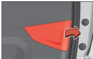
Abb. 118 Geöffnete Heckklappe: Abdeckung entfernen.
