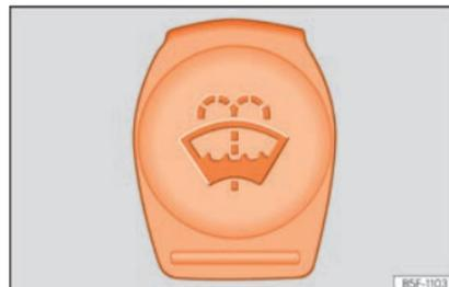
**Abb. 62** Im Motorraum: Deckel des Scheibenwaschbehälters.
