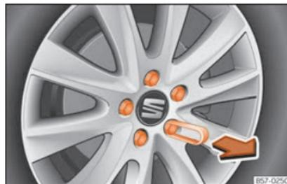
**Abb. 71** Rad: Radschrauben mit Deckel.
