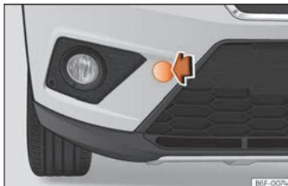
**Abb. 97** Vorderer Stoßfänger, rechte Seite: Abdeckung abziehen.
