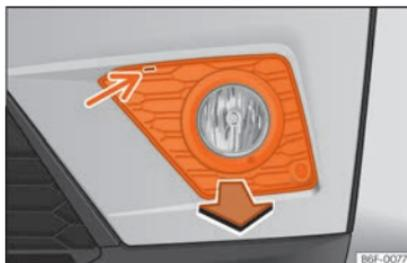
**Abb. 105** Nebelscheinwerfer: Gitter abnehmen
