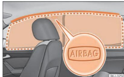
**Abb. 28** Einbauort und Entfaltungsbereich des Kopfairbags.
