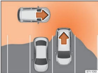
**Abb. 245** Schematische Abbildung des Ausparkassistenten: Überwachter Bereich des ausparkenden Fahrzeugs.
