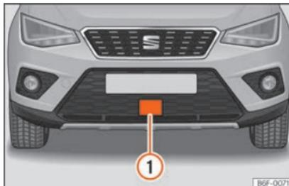
**Abb. 230** Im vorderen Stoßfänger: Radarsensor.
