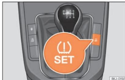
Abb. 284 Mittelkonsole: Taste für die Reifenkontrollanzeige
