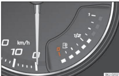
Abb. 121 Analoges Kombi-Instrument: Kraftstoffvorratsanzeige
