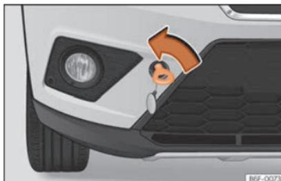
**Abb. 98** Vorderer Stoßfänger rechts: Eingeschraubte Abschleppöse
