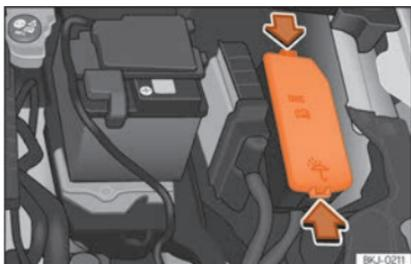
**Abb. 64** Im Motorraum: Abdeckung des Sicherungskastens.
