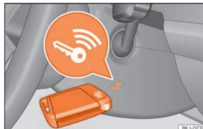
**Abb. 216** Rechts an der Lenksäule: Notstart.
