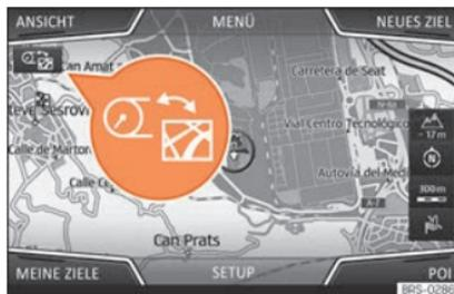
**Abb. 119** Infotainment-System: Taste zur Kartenübertragung
