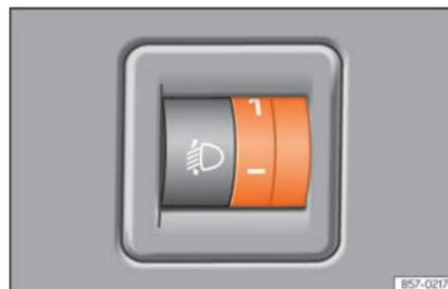
**Abb. 143** Instrumententafel: Regler für Leuchtweitenregulierung.
