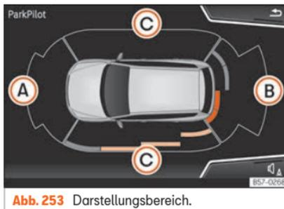
Die **Einparkhilfe plus** unterstützt den Fahrer beim Manövrieren und Einparken, indem erkannte Hindernisse *vor* und *hinter* dem Fahrzeug visuell und akustisch angezeigt werden.
