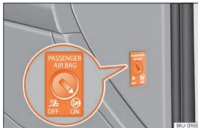
**Abb. 24** Schalter für Beifahrer-Frontairbag.
