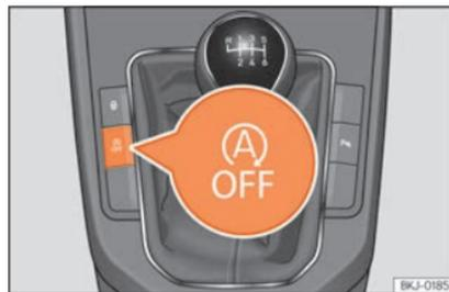
Abb. 224 Mittelkonsole: Systemtaste Start-Stopp.
