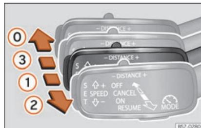
**Abb. 236** Auf der linken Seite der Lenksäule: dritter Hebel für die Betätigung der automatischen Distanzregelung.
