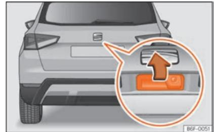
**Abb. 8** Heckklappe: Haltegriff
