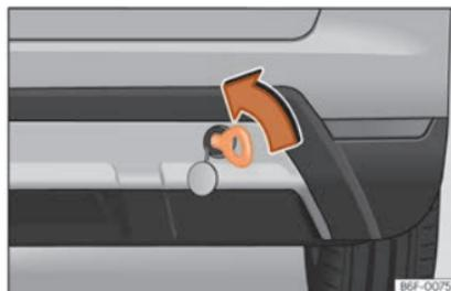
**Abb. 100** Hinterer Stoßfänger rechts: Eingeschraubte Abschleppöse
