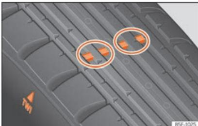
Abb. 282 Reifenprofil-Verschleißanzeiger
