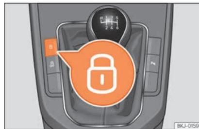
Abb. 134 Taster für Zentralverriegelung
