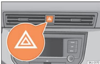
**Abb. 43** Instrumententafel: Schalter für die Warnblinkanlage
