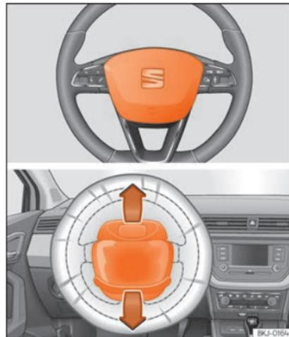
**Abb. 22** Einbauort Fahrerairbag: im Lenkrad. »
