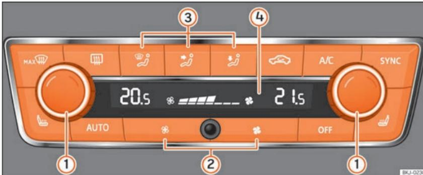
**Abb. 55** In der Mittelkonsole: Bedienelemente der Climatronic.
