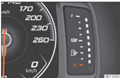
Abb. 122 Frei konfigurierbares Kombi-Instrument: Kraftstoffvorratsanzeige.
