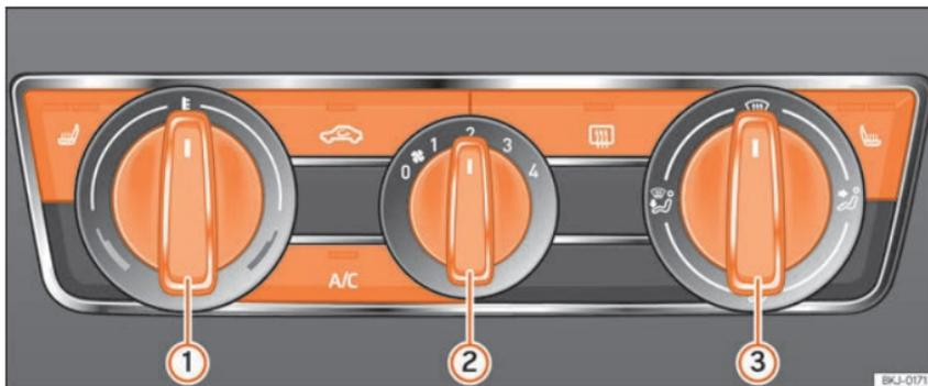
Abb. 169 Bedienelemente Klimaanlage in der Instrumententafel.
