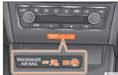
**Abb. 25** Instrumententafel-Mittelteil: Kontrollleuchte für abgeschalteten Beifahrer-Frontairbag.
