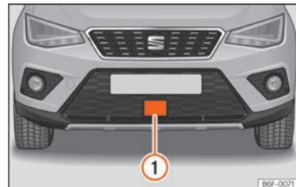
**Abb. 235** Im vorderen Stoßfänger: Radarsensor.
