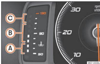
Abb. 124 Frei konfigurierbares Kombi-Instrument: Motorkühlmitteltemperatur-Anzeige.
