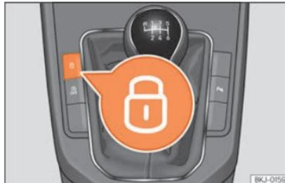
Abb. 5 Mittelkonsole: Zentralverriegelungstaster.
