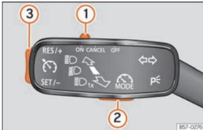
**Abb. 227** Links von der Lenksäule: Hebel und Tasten zur Bedienung des Geschwindigkeitsbegrenzers.
