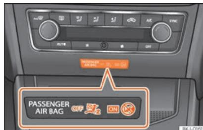
Abb. 95 Instrumententafel-Mittelteil: Kontrollleuchte für abgeschalteten Beifahrer-Frontairbag.
