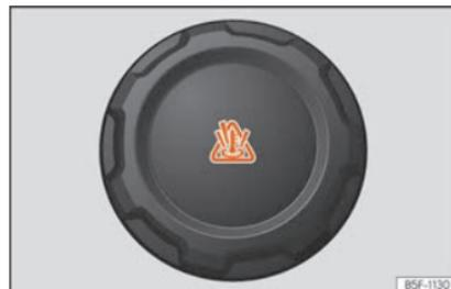
**Abb. 60** Motorraum: Deckel des Motorkühlmittelausgleichsbehälters
