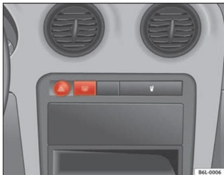
Abb. 57 Instrumententafel: Schalter Heckscheibenheizung
