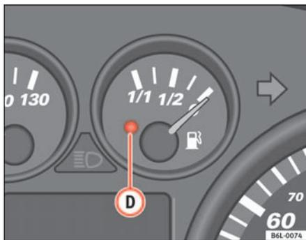
Abb. 33 Kraftstoffvorrats-Anzeige
