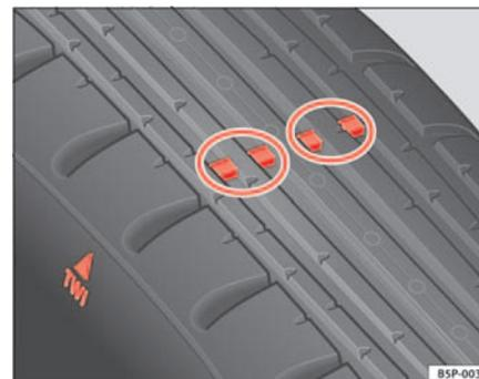
Abb. 129 Prinzipdarstellung Reifenprofil: Verschleißanzeiger ▶
