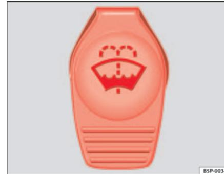
**Abb. 126** Im Motorraum: Deckel des Scheibenwaschwasserbehälters
