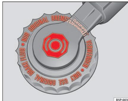
**Abb. 128** Im Motorraum: Abdeckung des Bremsflüssigkeitsbehälters
