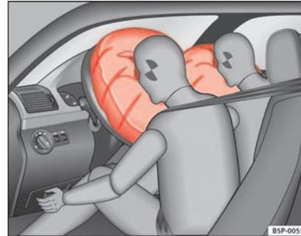
**Abb. 18** Aufgeblasene Frontairbags
