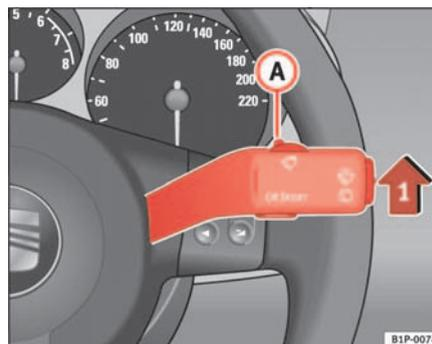
Abb. 64 Scheibenwischerhebel
