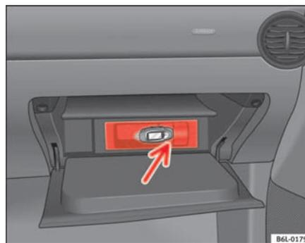
**Abb. 85** Anschluss USB\* im Handschuhfach auf der Beifahrerseite.
