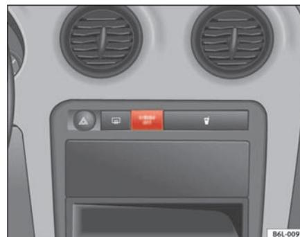
Abb. 25 Kontrollleuchte für Abschaltung der Beifahrerairbags
