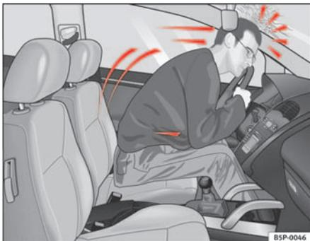
**Abb. 8** Der nicht angegurte Fahrer fliegt nach vorne
