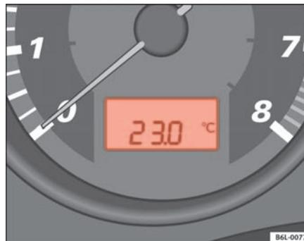
Abb. 37 Display im Kombiinstrument: Außentemperaturanzeige.
