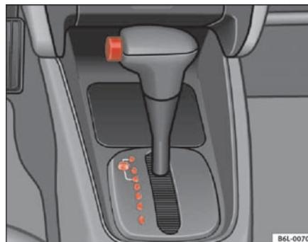
**Abb. 97** Ausschnitt aus der Mittelkonsole: Wählhebel vom Automatikgetriebe
