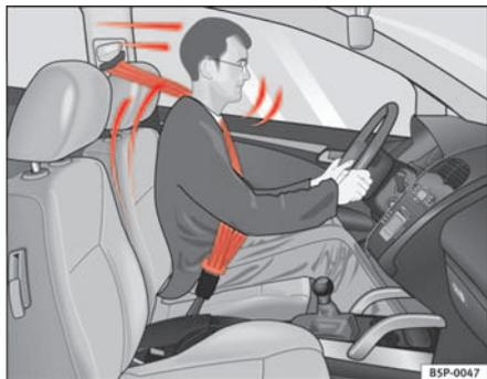
**Abb. 10** Angegurterter Fahrer, der bei einem plötzlichem Bremsmanöver vom richtig angelegten Sicherheitsgurt aufgefangen wird
