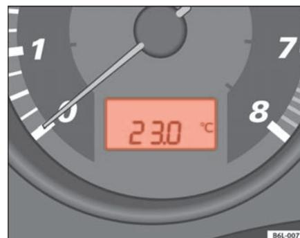
Abb. 35 Display im Kombiinstrument: Außentemperaturanzeige ▶
