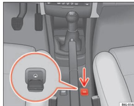
Abb. 83 Anschluss für einen zusätzlichen Audio-Eingang
