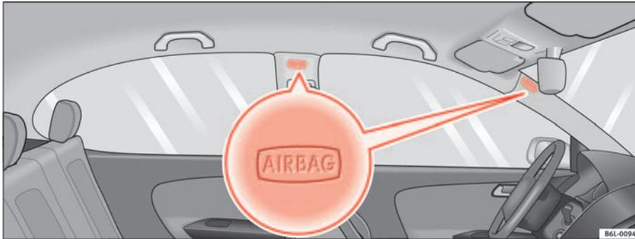
**Abb. 22** Einbauort der Kopfairbags auf der linken Fahrzeugseite
