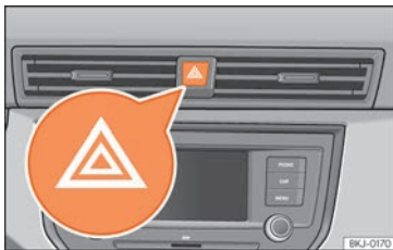
Abb. 109 Instrumententafel: Schalter für Warnblinkanlage.
