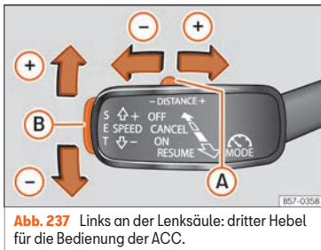
Abb. 236 Links an der Lenksäule: dritter Hebel für die Bedienung der ACC.
