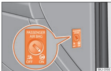
Abb. 17 Schlüsselschalter zum Ein- und Abschalten des Beifahrerairbags.
