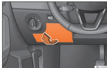
Abb. 51 Auf der Fahrerseite in der Instrumententafel: Abdeckung des Sicherungskasten.
