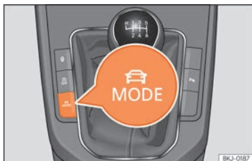
Abb. 220 Neben dem Schalthebel.: Taste MODE .
