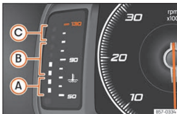
Abb. 76 Frei konfigurierbares Kombiinstrument: Motorkühlmittel-Temperaturanzeige.
