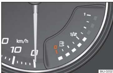
Abb. 72 Analoges Kombi-Instrument: Kraftstoffvorratsanzeige
