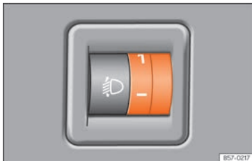
Abb. 110 Neben dem Lenkrad: Regler für die Leuchtweitenregulierung.
