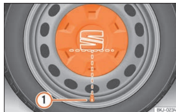
Abb. 34 Korrekte Anbringung der Radvollblende für Stahlfelgen.
