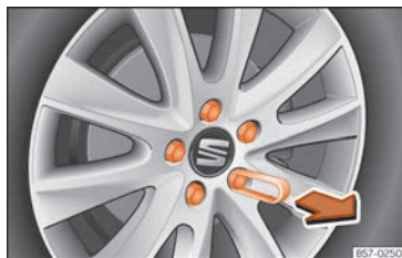
Abb. 36 Rad: Radschrauben mit Deckel.
