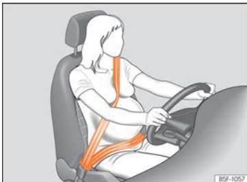
Abb. 13 Gurtbandverlauf bei schwangeren Frauen.
