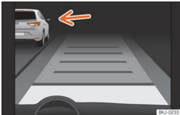
Abb. 238 Am Bildschirm des Kombi-Instruments: ACC aktiv, Fahrzeug auf der linken Seite erkannt
