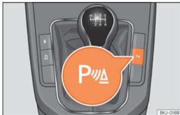
Abb. 244 Mittelkonsole: Taste für Einparkhilfe (je nach Ausführung).
