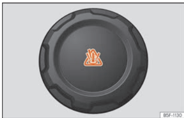
Abb. 273 Motorraum: Deckel des Motorkühlmittelausgleichsbehälters.
