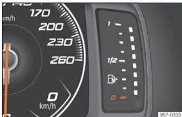
Abb. 73 Frei konfigurierbares Kombiinstrument: Kraftstoffvorratsanzeige
