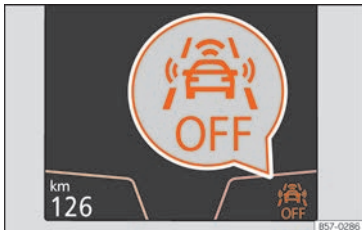
Abb. 230 Am Bildschirm des Kombi-Instruments: Anzeige, dass Front Assist ausgeschaltet ist.
