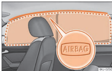
Abb. 21 Einbauort und Entfaltungsbereich des Kopfairbags.
