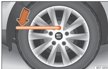
Abb. 38 Radwechsel: Radschrauben lockern.
