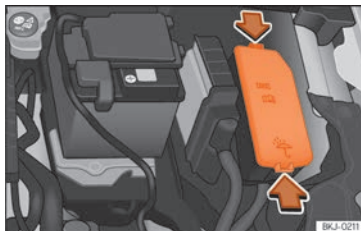
Abb. 52 Im Motorraum: Abdeckung des Sicherungskastens.
